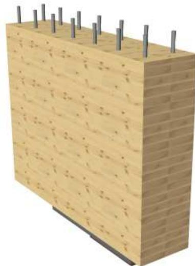
La liaison est assurée par les tubes scellés par collage dans les poutres. Les poutres sont percées en usine, et l'espace entre le bois et les tubes est comblées par une résine.
