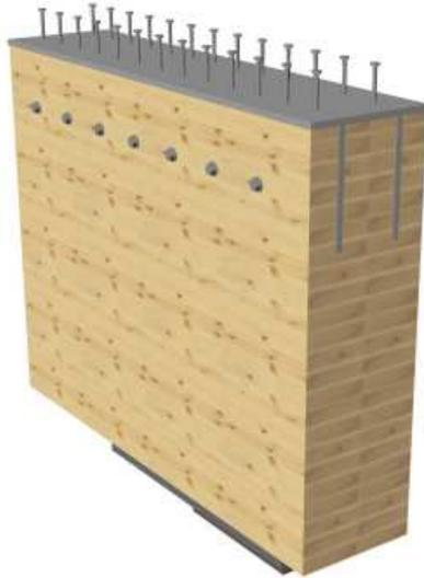
Un demi-profilé métallique en T est pris en sandwich et liaisonnés aux poutres bois par une série de broches transversales disposées tout le long des poutres. Ce type de liaison est plus performant en termes de rigidité dans la mesure où on multiplie les plans de cisaillement de l'organe par le nombre de plans cisailés. Si notre poutre principale est constituée de quatre poutres liaisonnées à deux profilés en T, cela revient à multiplier la capacité résistante de l'organe par 4.
