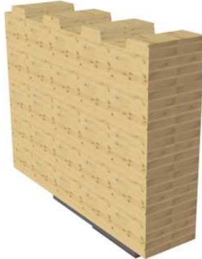
Une liaison assurée par une série d'encoches transversales offre une bonne raideur. En effet, la transmission de l'effort de cisaillement se fait par compression de la dalle sur les faces latérales du bois en bout et par adhérence. Le maintien de la dalle se fait par le poids propre de la dalle.
