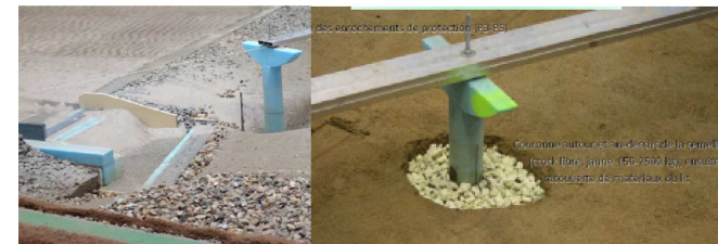
Modélisation physique (viaduc de la LEO – Avignon)
