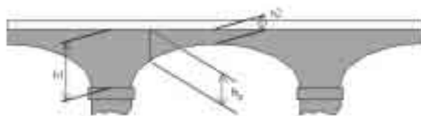
Figure 5 : Vulnérabilité des voûtes en maçonnerie
