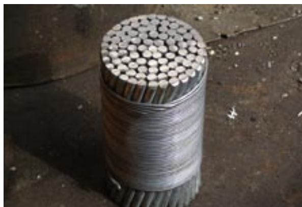
Photos 11 : fabrication des haubans TMC
