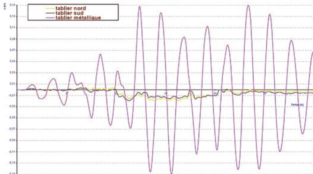
Figure 12 : déplacement des tabliers en fonction du temps – Source : Sètra
