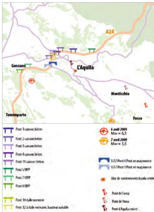
Figure 7 : repérage des ouvrages sur l'A24 – Source : Sétra
