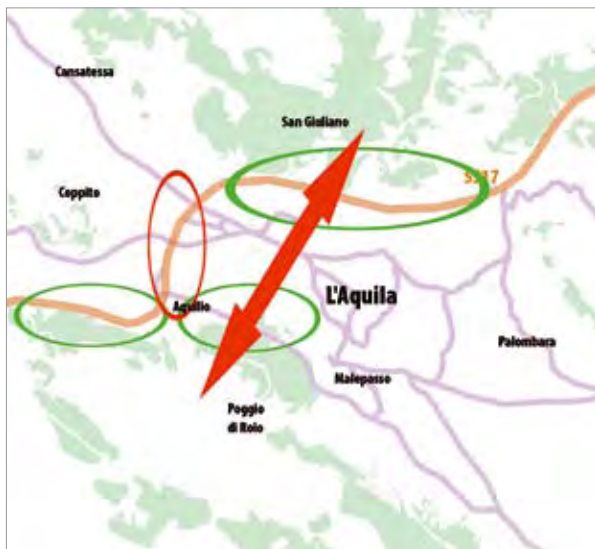
Figure 17 : sollicitation des ouvrages selon la directivité du séisme Source : Sétra
