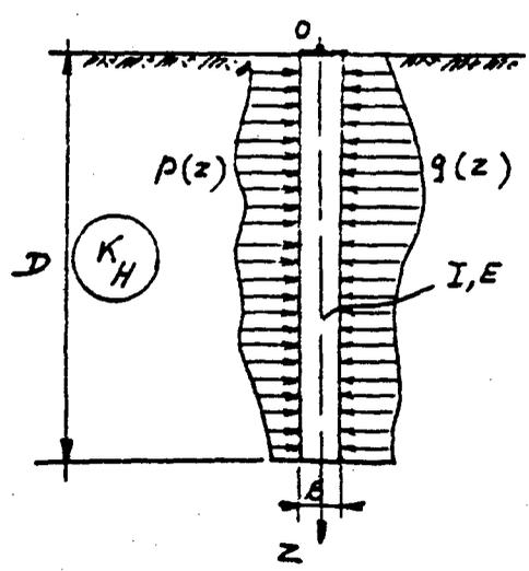
pieu subit des déplacements horizontaux  $W(Z)$  et le sol développe des réactions latérales  $p(Z)$  telles que :
