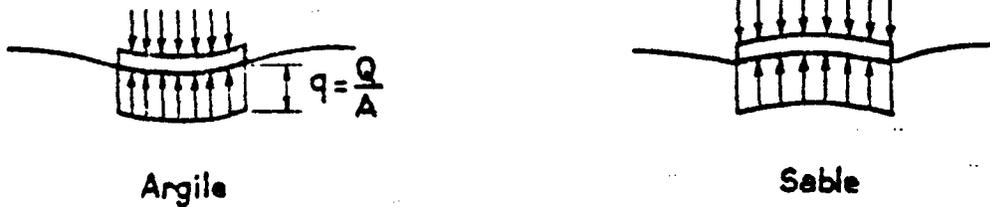
Si au contraire la semelle est rigide, c'est-à-dire indéformable par rapport au sol, elle lui impose une déformation constante sur toute la surface de charge et la distribution des pressions de contact n'est pas uniforme.
