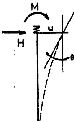
Soient  $A_p$ ,  $B_p$ ,  $C_p$  les coefficients de déformabilité du fût de pile, fondation comprise, la déformabilité totale de la pile sera définie par :
