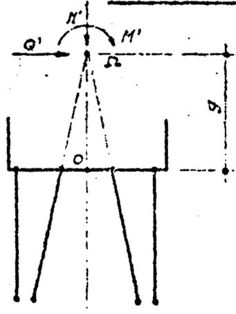
Si on calcule les déplacements  $\theta'$ ,  $u'$ ,  $v'$  en  $\Omega$ , point de concours des pieux inclinés où les éléments de réduction des efforts appliqués sont :  $M'$ ,  $Q'$ ,  $N'$ , on a :
