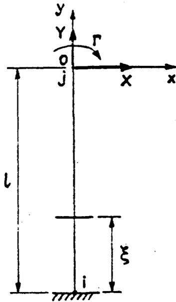
Si l'élément  $ij$ , de longueur  $l$ , est orienté suivant l'axe  $oy$ , l'origine  $O$  étant confondue avec l'extrémité  $j$ , on a :
