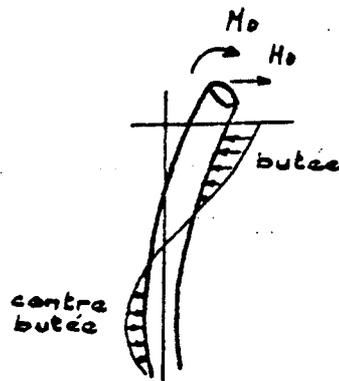
Un pieu soumis à une force horizontale ou à un couple appliqués en tête résiste en fléchissant plus ou moins, selon sa raideur relative ce qui entraîne une réaction latérale du terrain.
