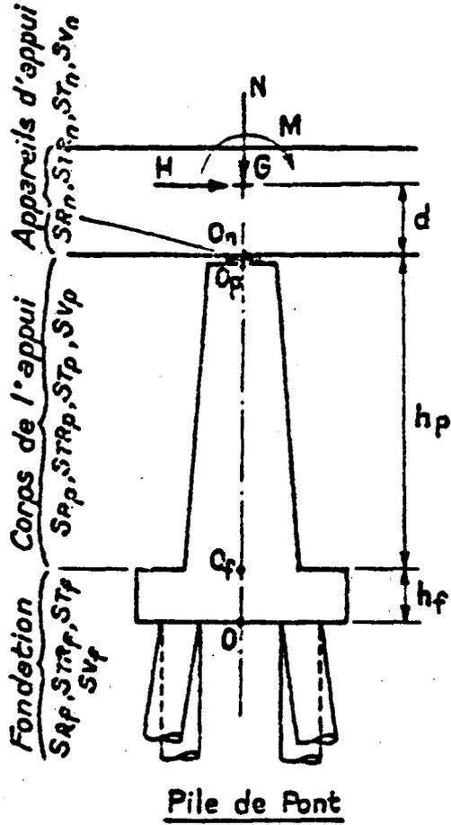
Les déplacements en tête de l'appui s'obtiennent par superposition de déplacements relatifs à chaque élément.
