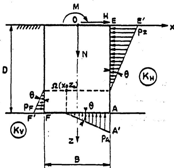
rotation  $\Omega$ . Mais la position de  $\Omega$  dépend des sollicitations. Pour chaque ensemble de forces  $N$ ,  $M$ ,  $H$ , il existe une position bien déterminée du centre instantané de rotation.
