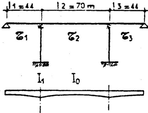
La distance de la fibre moyenne du tablier à la face supérieure de la pile est égale à 1,72 m
