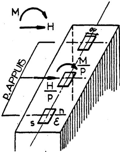
Si les piles ne comportent qu'une seule file d'appuis en néoprène, ceux-ci subissent une rotation  $\theta$  sous l'effet de M et un déplacement horizontal u sous l'effet de H.
