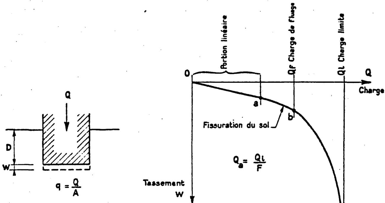
La charge de fluage  $Q_f$  marque le seuil des tassements croissant rapidement. On lui applique des coefficients de sécurité plus faibles (1,25 à 1,6).
