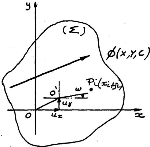
Sous l'effet de  $\phi$ , ( $\Sigma$ ) subit un déplacement d'ensemble D se décomposant en une translation ( $u_x$ ,  $u_y$ ) et une rotation ( $\omega$ ).
