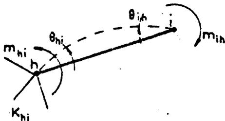
Considérons un de ces éléments  $ih$  et supposons connus ses coefficients de souplesse  $a$ ,  $b$ ,  $c$  et d'élasticité  $K_{hi}$  du nœud  $h$ , à l'égard de l'élément.
