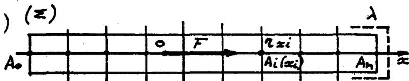
Le centre de dilatation  $O$  de l'ouvrage est le barycentre des appuis affectés des masses  $r_{xi}$ . Sous
