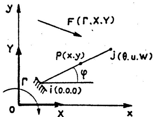
6.11- Considérons d'abord un élément rectiligne, de fibre moyenne  $ij$ , d'inertie  $I$  et de section  $S$ , faisant partie d'une structure hyperstatique plane et dont l'appui  $i$  est supposé fixe dans le plan de la structure (encastrement)
