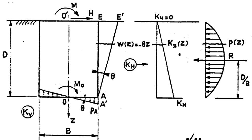
Dans les terrains pulvérulents, il paraît plus exact de considérer que le coefficient de réaction horizontal du sol n'est pas constant mais varie linéairement avec la profondeur :
