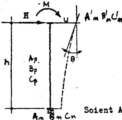
Dans certaines circonstances (poutres à béquilles, portiques), on est amené à disposer les appuis en néoprène au pied des piles, afin de réduire la valeur des moments de flexion transmis aux fondations.
