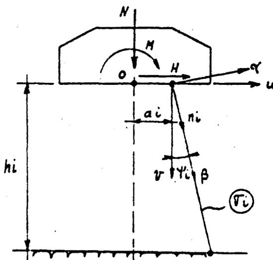
La fondation est soumise à un effort vertical  $N$ , à un moment fléchissant  $M$  et à un effort horizontal  $H$  appliqués au centre de gravité  $O$  de la base de la semelle. Chaque pieu de section  $\sigma_i$ , incliné de  $\psi_i$  sur la verticale et situé à la distance  $a_i$  du point  $O$ , supporte un effort normal égal à  $n_i$
