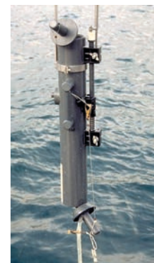
Figure 297 : Prélèvement d'eau à des profondeurs différentes pour l'analyse des matières en suspension©
