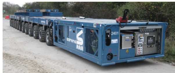
Figure 110 : Assemblage de deux éléments Kamag. Cf. le poste de contrôle et le boîtier de commande. - Capacité de 134/170 tonnes
