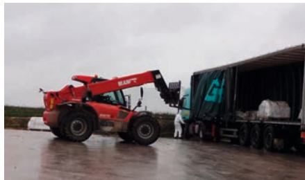
Figure 94 : Déchargement de camion (les doubles emballages doivent être intègres, les palettes doivent avoir été disposées et acheminées à plat en un seul niveau) - ISDD de Drambon (site de SITA-FD)
