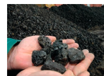
Figure 96 : « cofalit » (matériau issu de la vitrification d'amiante) (INERTAM)
