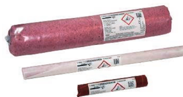
Figure 127 : Cartouche de dynamite gomme (<> calibre), ici l'Eurodyn 2000 de Titanobel (site internet). C'est cette dynamite qui a été utilisée dans l'exemple de démolition exposé au chapitre III 3.5.1. Sous forme pâteuse de couleur rose, encartouchées soit en gaine plastique clippée aux deux extrémités, soit en papier paraffiné. Elle est livrée en carton de 25 kg
