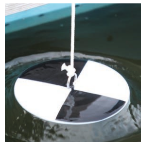
Figure 296 : Mesure de turbidité avec le disque de Secchi©
