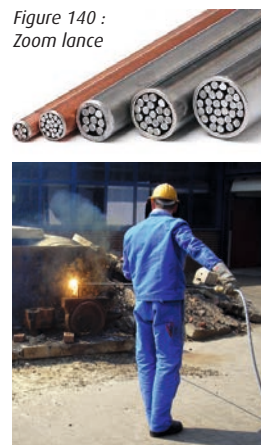
Figure 141 : Lance thermique après l'allumage - wikipédia - © Sauerstoffkernlanze CC-BY-SA-2.0
