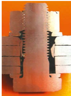
Figure 51 : Coupe d'un boulon injecté
