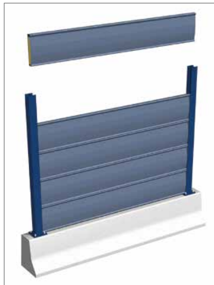
Figure 4 : Constitution d'un écran métallique (Source : Mice)
