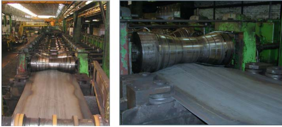
Figure I.2.10 - Stands de profilage à froid - crédit : Arcelor Mittal
