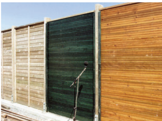
Photo 7 : écran réfléchissant composé de poteaux et de panneaux en pin teinté (prototype à l'essai)
