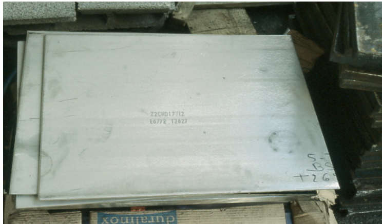
Photo 43 – Plaques d'inox en "coffrage perdu" – nuance Z2 CND 17/12
