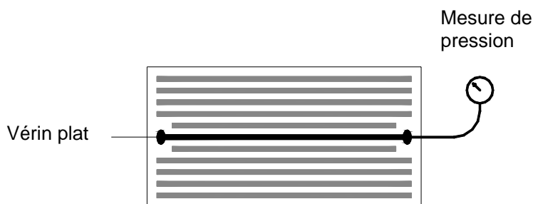
Figure 44 - Principe d'un appareil d'appui à vérin plat
