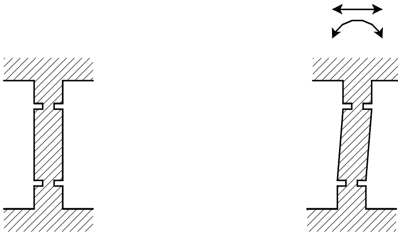
Figure 40 - Principe des bielles de béton
