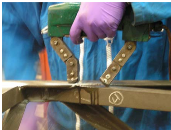
Contrôle par magnétoscopie (photo CETE Est)
