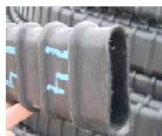
Gaine plate nervurée en PEHD (Photo LROP)
