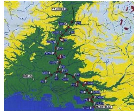
L'ensemble de la ligne du TGV Méditerranée est équipé de capteurs permettant de couper instantanément la circulation des trains en cas de secousse sismique.
