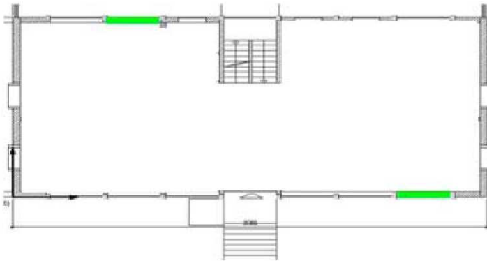
Deux nouvelles voiles en béton armé dans le sens longitudinal
