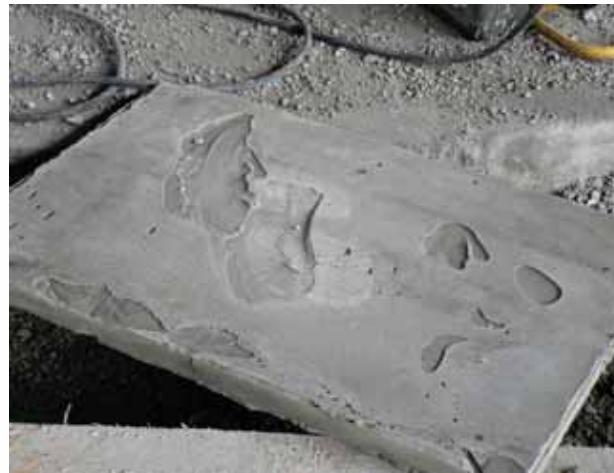
Matage supérieur 1er essai
