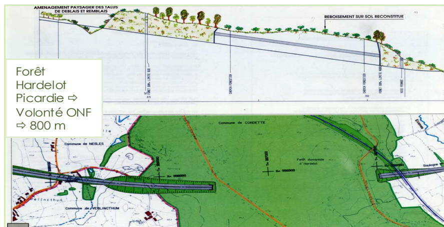
Pont écologique : Tranchée couverte
