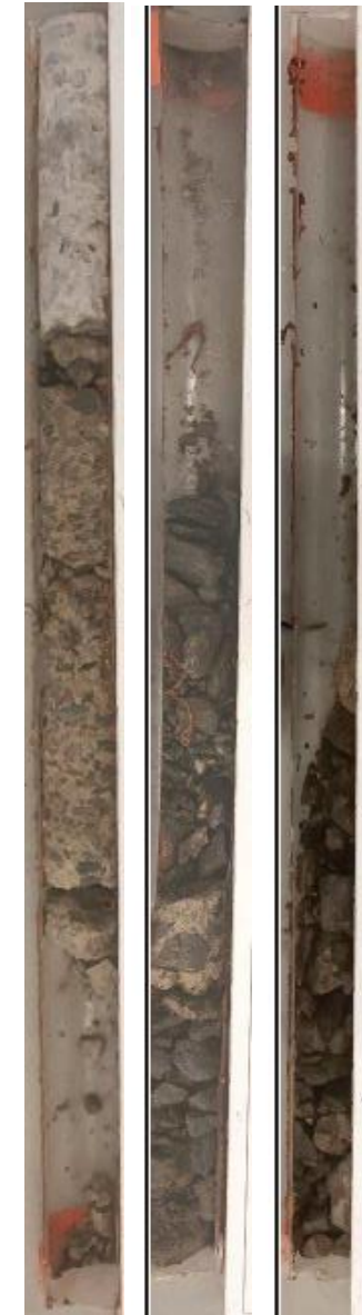
Exemple de sondage carotté (Pile P3)
