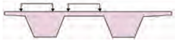
Schéma 9 : Position transversale pour le moment négatif sur P2 - nervure de gauche.
