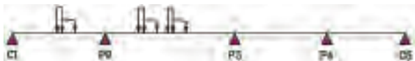
Schéma 8 : Position longitudinale pour le moment négatif sur P2 - nervure de droite.
