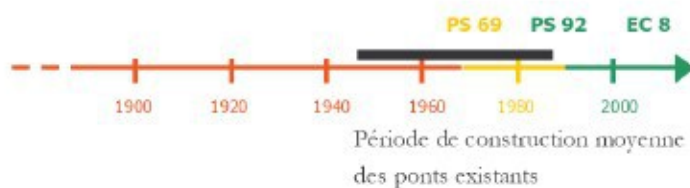
Figure 1 : Période de construction moyenne des ponts et évolution de la réglementation parasismique en France
