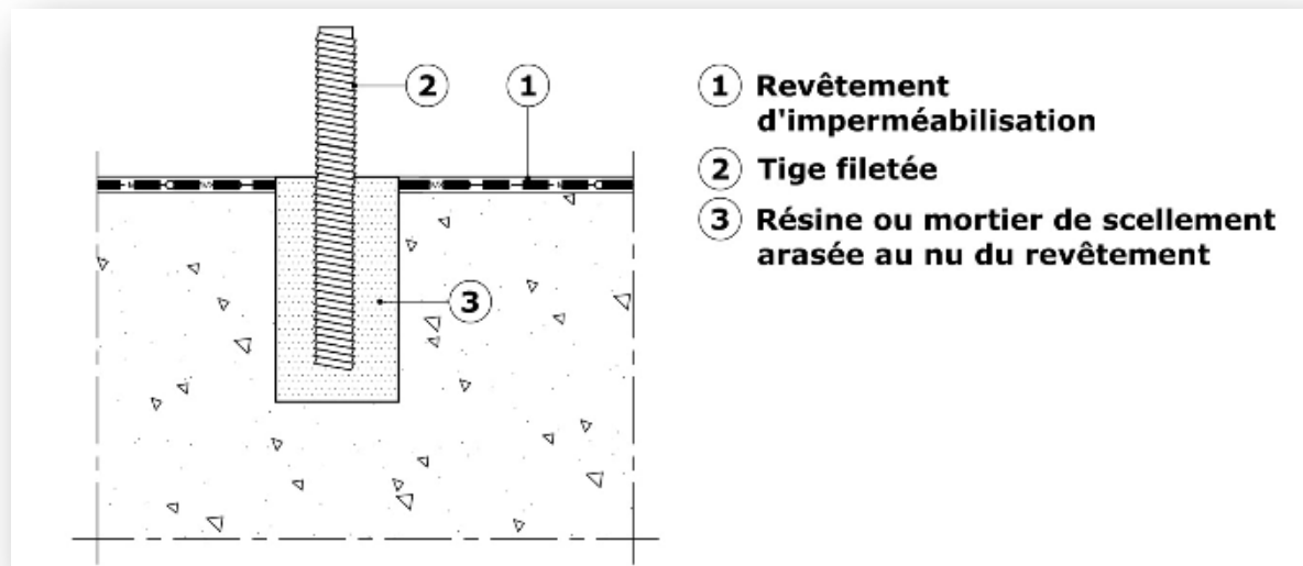
Schéma RIS 11 Exemple de scellement direct
