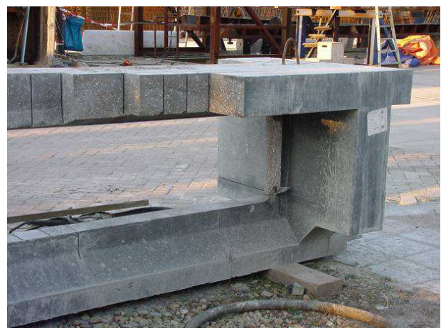
Figure 9 : élément témoin pour le pont de Bourg les Valence en BSI®, vue avant et après sciage Figure 9: mock-up of the Bourg les Valence bridge in BSI®, before and after sawing
