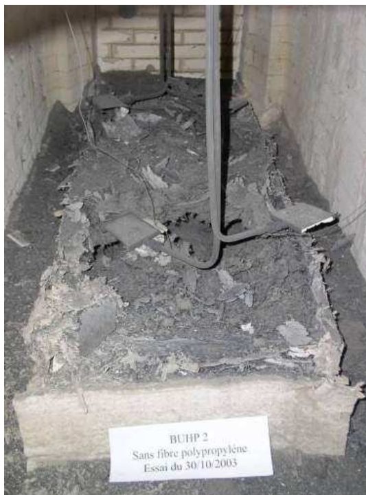
Figure 11 : Epreuve de BFUP CERIB UHPC II sans fibre (gauche) et avec fibre (droite) après exposition au feu ISO834.
