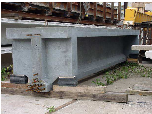
Figure 9 : élément témoin pour le pont de Bourg les Valence en BSI®, vue avant et après sciage Figure 9: mock-up of the Bourg les Valence bridge in BSI®, before and after sawing
