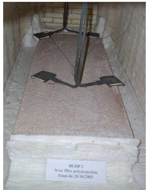
Figure 11 : Epreuve de BFUP CERIB UHPC II sans fibre (gauche) et avec fibre (droite) après exposition au feu ISO834.
