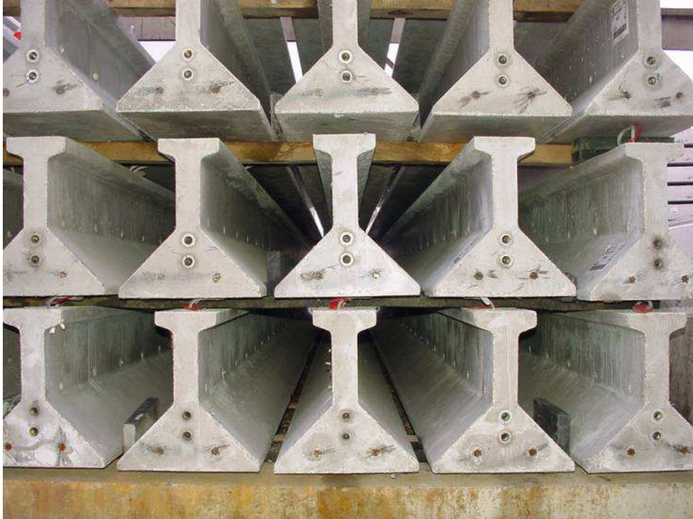
Stockage des poteaux utilisés pour le soutènement / Storage of the piers used for earth retaining
