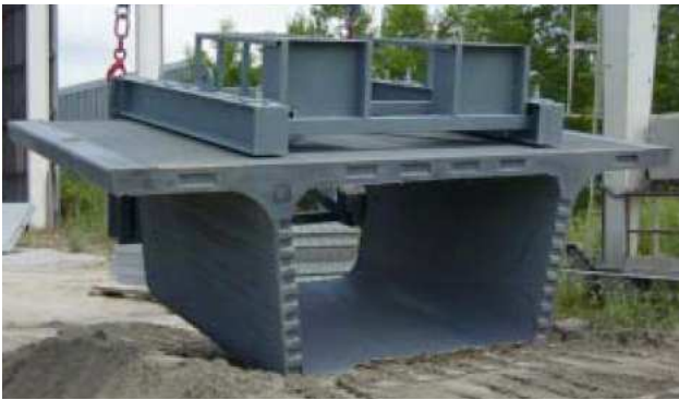
Figure 7 : élément témoin échelle 1 pour le pont PS34 en BCV®, avec schéma des prélèvements effectués
