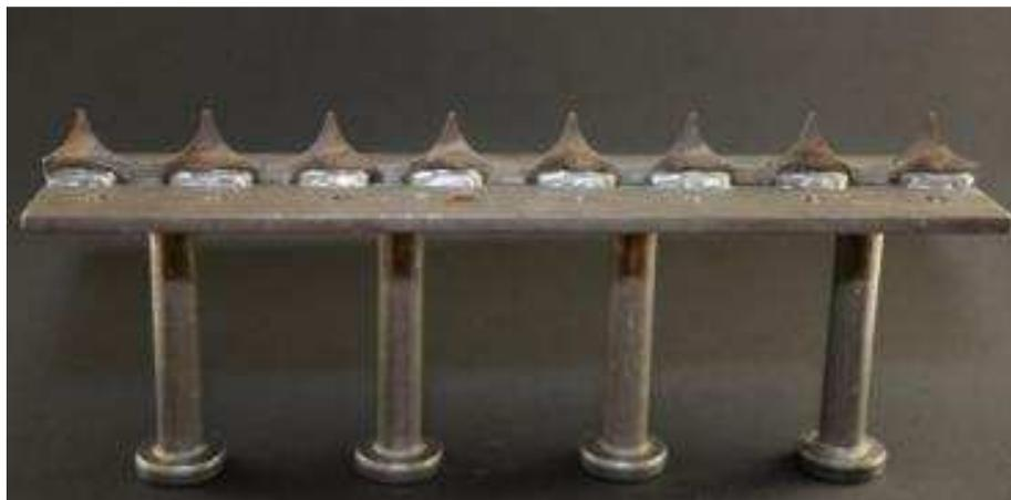
Figure 7-10 : Essais de type « push out » pour la mesure de la rigidité des connecteurs métalliques [Blonski 2009], laboratoire Navier, (ENPC-Ifsttar, CNRS). A gauche le corps d'épreuve en cours de réalisation avant bétonnage, à droite, corps d'épreuve en cours d'essai
