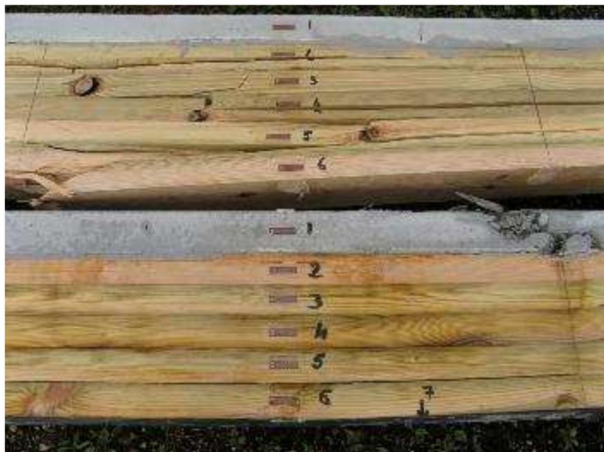
Figure 7-34 : Comparaison des résultats obtenus par Nguyen. A gauche poutres non renforcées ( $F_r = 100$  kN environ), à droite poutres renforcées par 3 lamelles de CFRP ( $F_r = 150$  kN environ). La différence de performance est notable.
