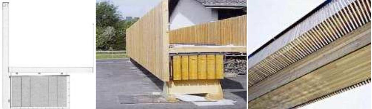
*A gauche : coupe transversale, où sont visibles les poutres, le hourdis et les parapets
