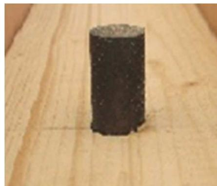
Figure 7-4 : Tire-fonds SFS vissés dans une poutre bois puis coulés dans un béton fibré ultra performant (Blonski 2009). L'effet d'une grande densité de tire fonds, peu économique dans un projet, est étudié ici à cause de la grande résistance du béton à ultra hautes performances autorisant des forts cisaillements
