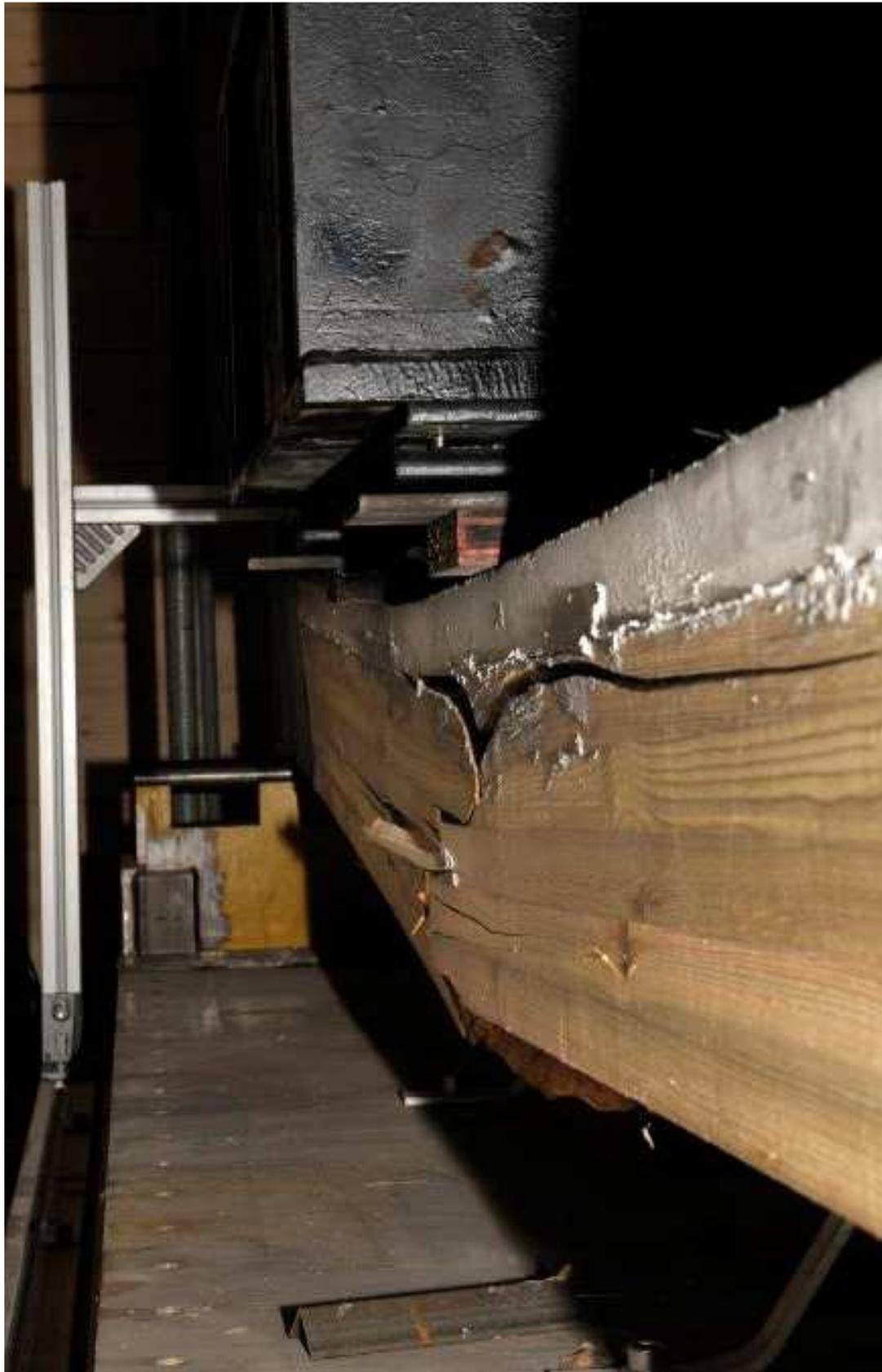
essai de flexion sur poutre mixte bois- béton. ENPC. Photo RLR
