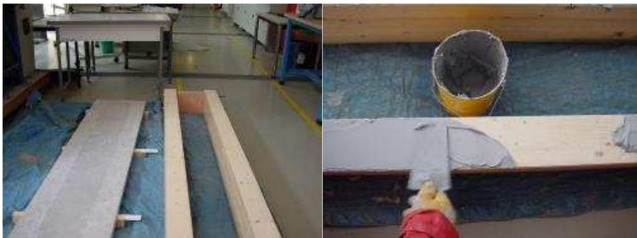
Figure 7-17 : A gauche, corps d'épreuve de 3 m (2 poutres BLC :  $b = 0,115$  m,  $h = 0,23$ , BFUP :  $h = 0,04$  m,  $b = 0,5$  m), à droite essai de flexion. [Pham 2008, Le Roy et al. 2009]
