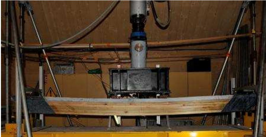
Figure 7-31 : Préparation des poutres dans l'atelier CMBP de lamellé collé. Lamelles de CFRP (Sika carbodur épaisseur 1 mm largeur 80 mm)
