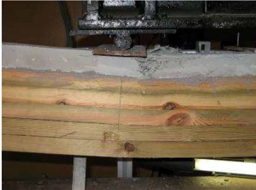
Figure 7-33 : Comparaison des modes de rupture. En haut poutre non renforcée, en bas poutre renforcée par 3 lamelles de CFRP
