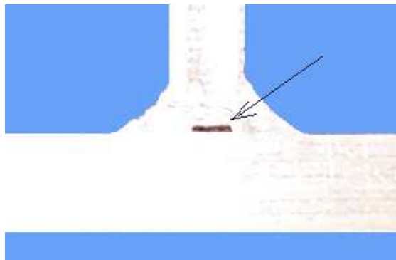
Figure 5-11 : Défaut de 2mm pour l'essai TGAP
