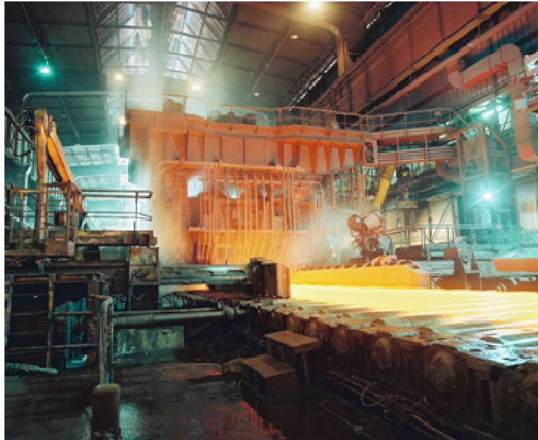
Photo 2.6 : cage de laminage quarto de GTS Industries à Dunkerque (©Dillinger Hütte GTS - C. Manuelli)
