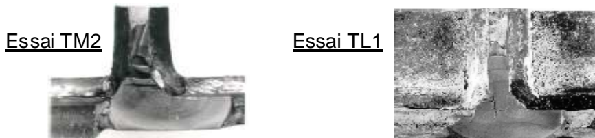
Figure 5-24 : Surface de rupture après ouverture des éprouvettes
