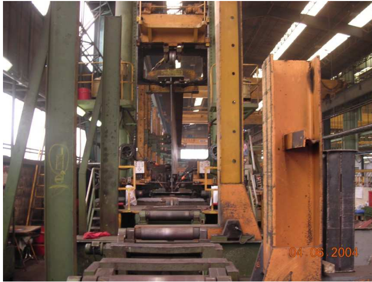
Photo 6.1.1 : Banc de soudage âme/semelle PRS (Photo CTICM - D. Bitar)
