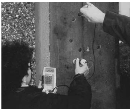
photo 2.2 : Mesures de potentiel
