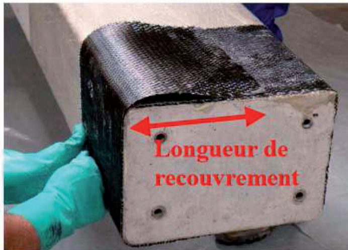
Figure 29 : Illustration de la longueur de recouvrement
