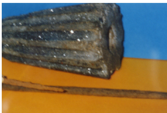
cône freyssinet en mortier au carborandum
