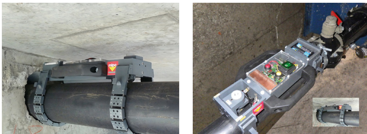
Photos 103a et 103b : Sonde capacitve du Cerema
