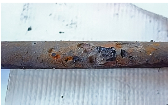
Photo 39 : Corrosion localisée par piqûres
