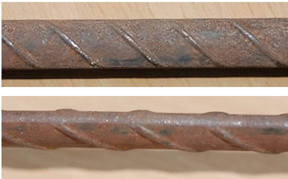
Photo 9 : Fils « Sigma Oval » du procédé KA
