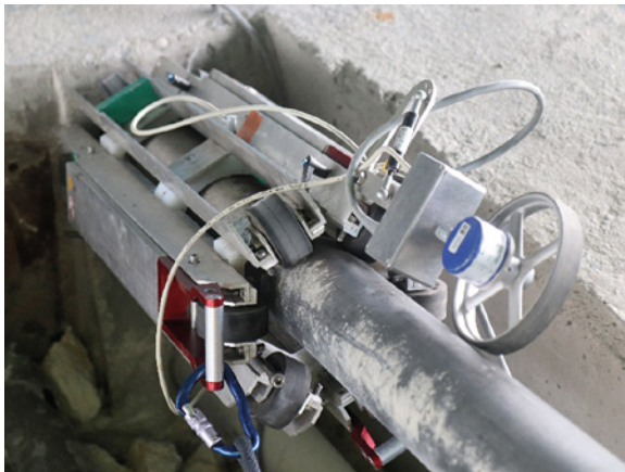
Photos 104a et 104b : « Aimants et bobine » d'auscultation magnétique
