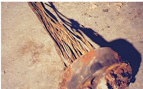
Photo 39 : Corrosion localisée par piqûres
