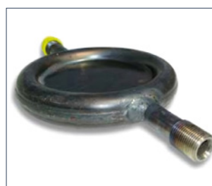
Photo 89 : Pour mémoire : Vérin plat de levage dit « vérin plat », levage à l'huile hydraulique, fossilisation au coulis de ciment, usage unique, non réversible et donc non étalonnable. Ce type de vérin est donc peu précis en mesure mais peut être utilisé en calage
