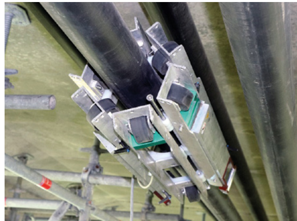
Photos 104a et 104b : « Aimants et bobine » d'auscultation magnétique
