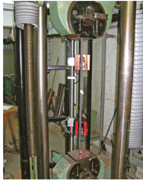
Photo 93 : Banc de mesure utilisé pour l'étalonnage des fils
