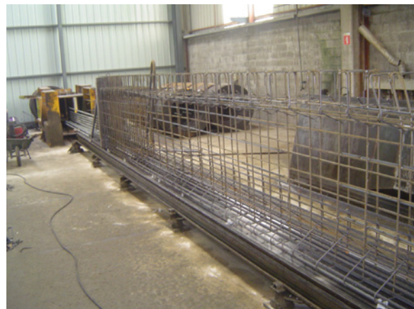
Photo 2 : Banc de préfabrication poutre PRAD (à gauche, on remarquera le gainage de torons près de l'appui)
