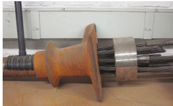
Photo 10 : Ancrage à clavettes d'un câble Freyssinet 12T13 du début des années 1980
