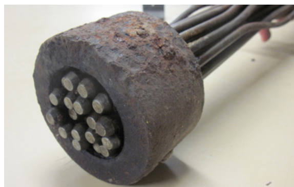
Photo 7 : Un câble à fils boutonnés (parallèles)
