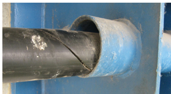
Photo 46 : Gaine fendue en pleine section
