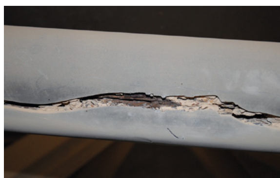
Photo 46 : Gaine fendue en pleine section
