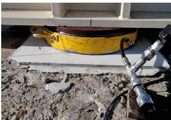
Photo 88 : Vérin de mesure : « Vérin plat à piston à portée sphérique », étalonnage sous presse de toute la chaîne hydraulique pour assurer la précision de la mesure, réutilisable
