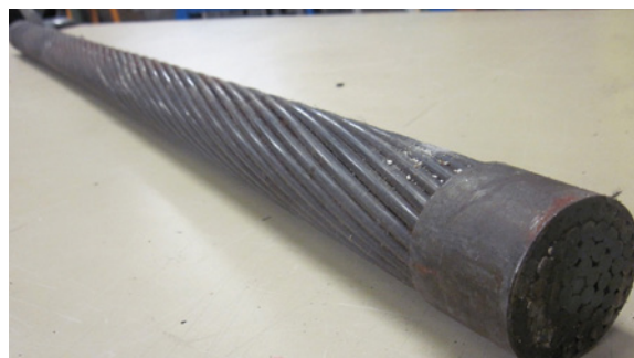
Photo 5 : Toron CO2 d'un câble à bosse (procédé SEEE)
