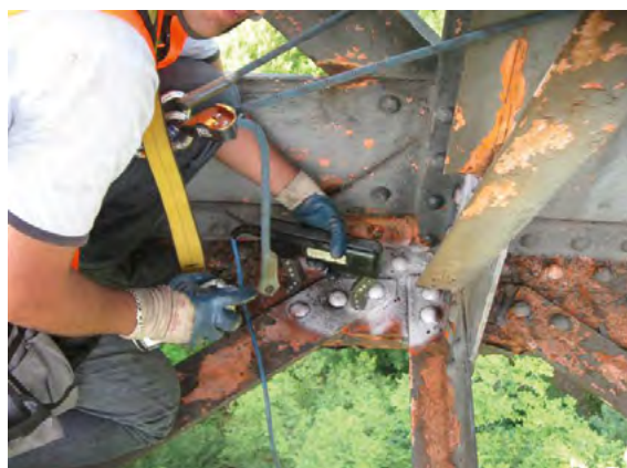
Illustration 139 : Contrôle d'un assemblage soudé par magnétoscopie
