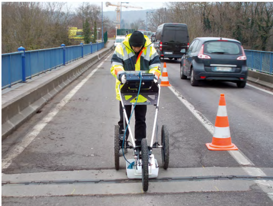
Illustration 129 : Réalisation de profils transversaux par technique RADAR
