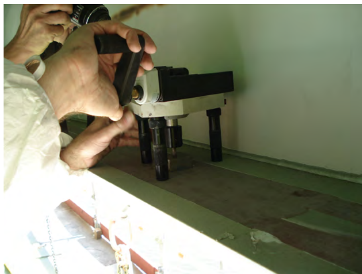
Illustration 157 : Essai d'arrachement pour réception du support
