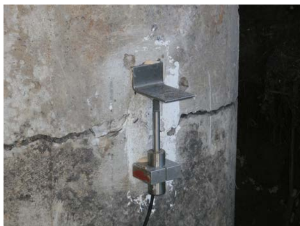
Figure 18a : L'instrumentation d'un ouvrage et son suivi permettent de valider les conditions de fonctionnement (ici suivi instrumenté d'une fissure).
