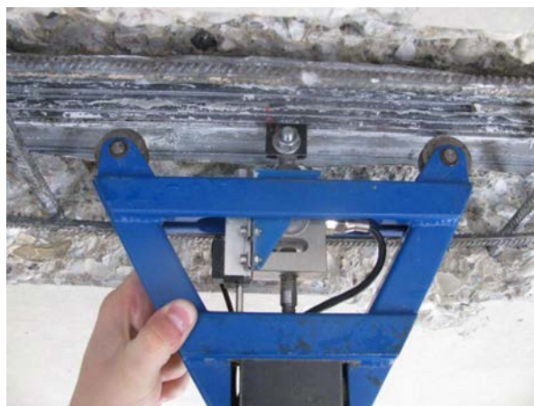
Figure 16b : Mesure de tension sur un fil de précontrainte par « arbalète »
