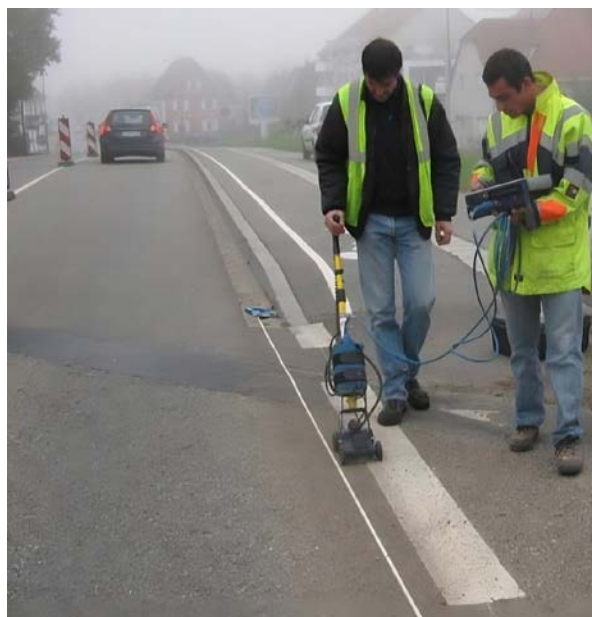
Figure 15b : Investigations radar sur chaussée : essai non destructif facilement réalisable
