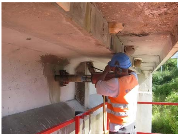
Figure 15a : Carottage : essai destructif dont il convient d'étudier avec soin la localisation
