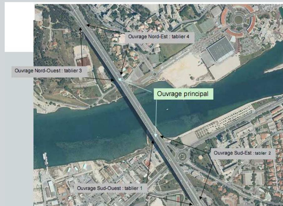
•De part et d'autre de l'ouvrage principal, des viaducs en béton précontraint forment des rampes d'accès.
