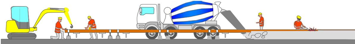
Figure A3-4 : Pose directe sur selle pour Tramway
