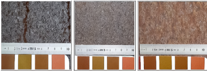
Figure 11 : Exemples d'images présentant l'aspect de la patine (le nuancier RAL figurant sur les photos correspond aux couleurs 8011, 8008, 8007 et 8004 respectivement de gauche à droite) (Source : Cerema)
