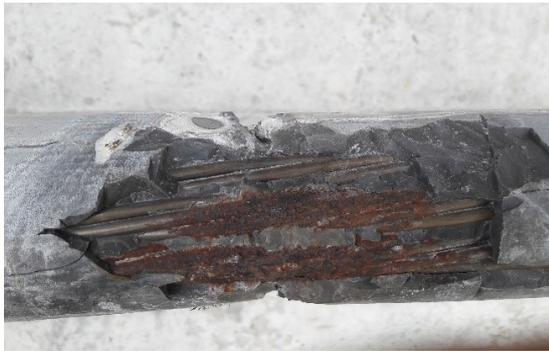
*Corrosion avancée du câble avec rupture de fils*
