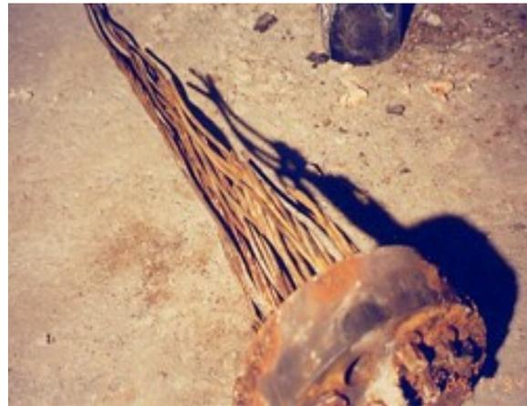
*Rupture d'un câble par corrosion*
