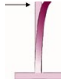
Figure 3.4 : pile de grande hauteur : La rigidité de ce type d'appui encastré à la base et libre en tête peut être évaluée à K_{pile} = 3EI/h^3 où h est la hauteur, I l'inertie et E le module élastique.
