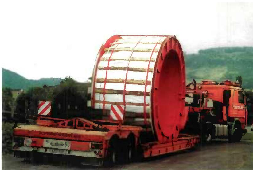
Photo 53 : livraison d'un hauban préfabriqué sur le chantier
