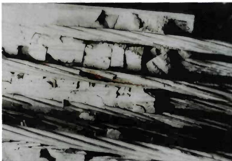
Photo 33 : toron rompu au cours d'un essai de fatigue
