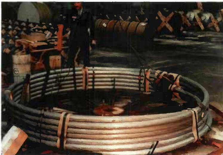
▲ Photo 50 : hauban TMC préfabriqué avec ses douilles d'ancrage.
