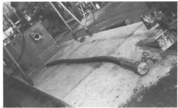
▲ Essai de démontabilité - Étape 4 : câble après extraction (il a conservé sa courbure) (photo R. Chaussin)
