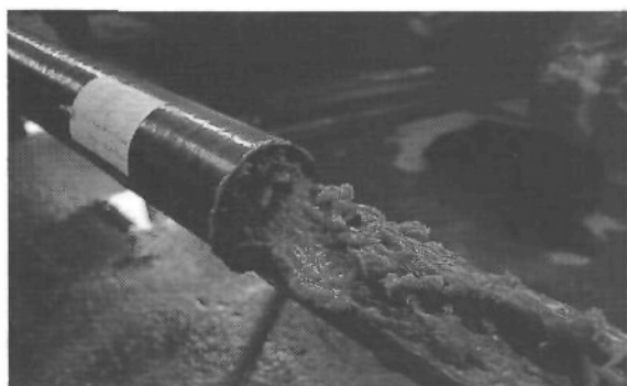
◀ Conduit en fibre de verre injecté à la cire (photo A. Chabert)
