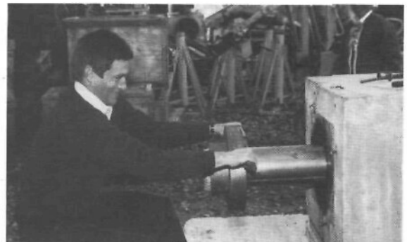
▲ Essai de démontabilité - Étape 2 : extraction du câble (photo R. Chaussin)
