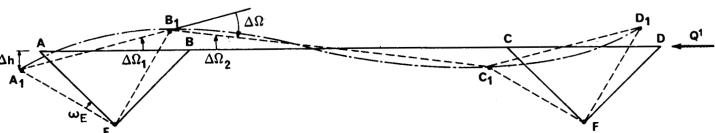
La figure ci-dessus montre schématiquement la déformation de l'ouvrage supposé articulé. Les triangles ABE et CDF étant indéformables et tournant respectivement autour de E et F, les déplacements verticaux des points A, B, C, D sont les mêmes en valeur absolue. Nous appelons  $\Delta h$  la valeur algébrique, orientée positivement vers le haut, du déplacement du point A (négative lorsque  $Q^i$  est positif).
