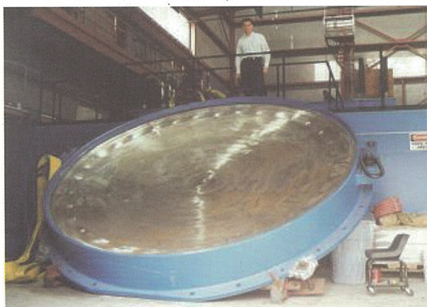
Photo 7 : Dispositifs frottants pendulaires de grandes dimensions utilisés en Californie pour le renforcement parasismique des ponts
