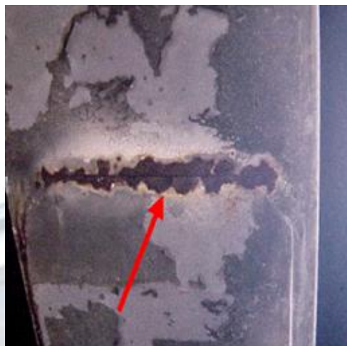
figure 104 Rupture fragile d'un ouvrage en fer puddlé/ crédit SNCF ©
