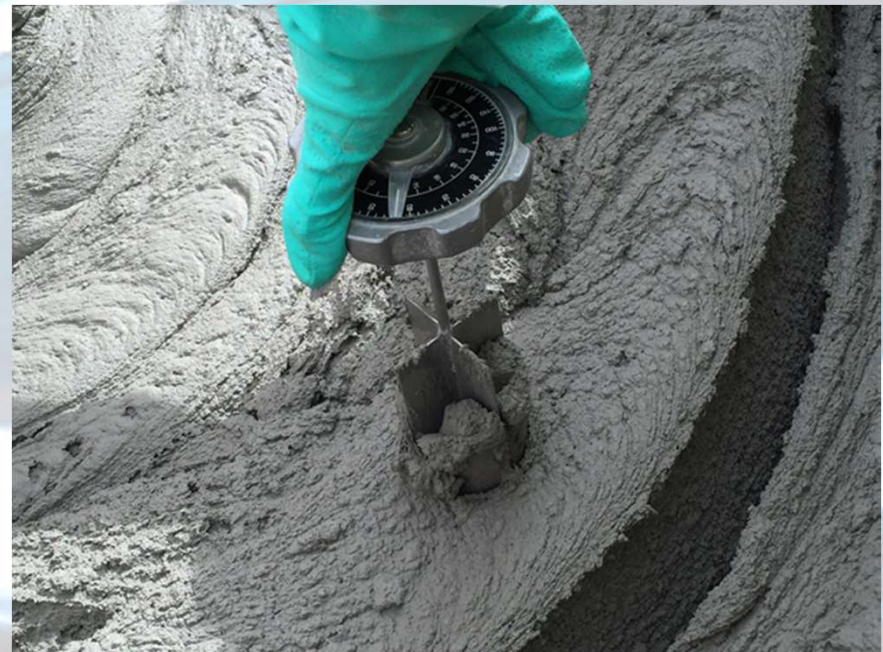
Vérification de la contrainte de cisaillement au scissomètre 8
