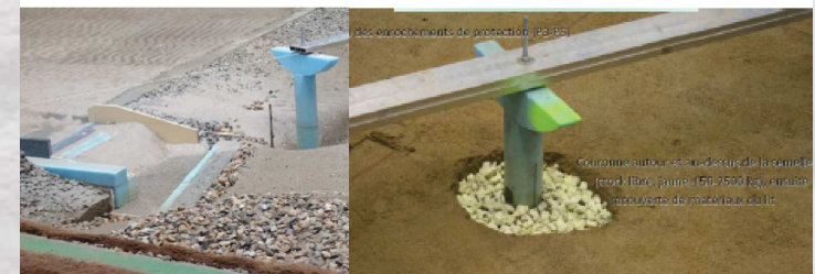
Modélisation physique (viaduc de la LEO – Avignon)
