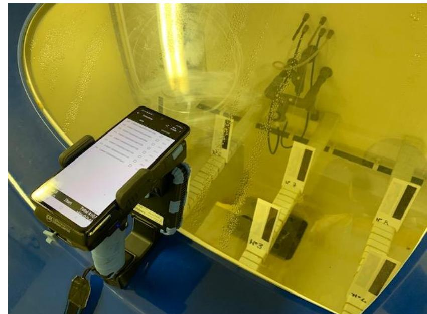
**NF EN ISO 16701** - Corrosion des métaux et alliages - Corrosion en atmosphère artificielle - Essai de corrosion accélérée comprenant des expositions sous conditions contrôlées à des cycles d'humidité et à des vaporisations intermittentes de solution saline
