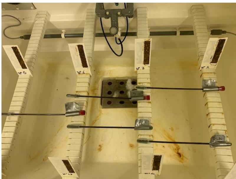
Mesure de corrosion par analyse d'image
