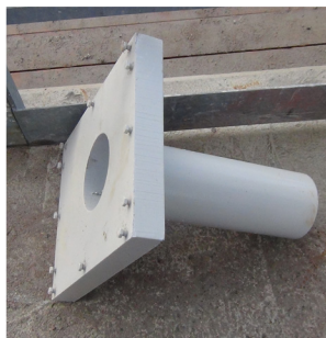
Photo 6.4 : tube trompette (©Alexis Piron-EDF)
