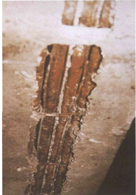
Les conditions de mise en œuvre du béton peuvent également affecter sa résistance. Il peut s'agir d'un traitement thermique mal conduit ou de mauvaises conditions de serrage du béton (insuffisance ou excès de vibration).
